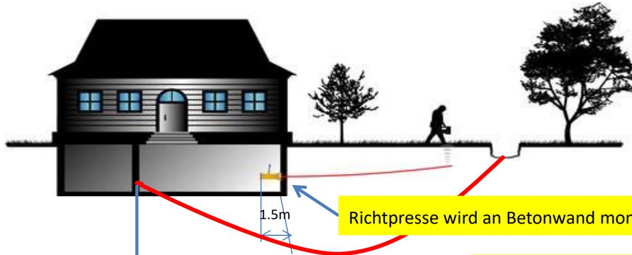
Richtpresse wird an Betonwand montiert.
